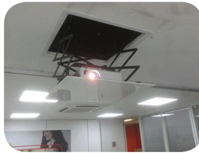
O lift permite um acabamento sofisticado, criando uma sensação de modernidade e praticidade ao ambiente. Também é acionado através de sensor de corrente, ou seja, quando o projetor é ligado, entra em funcionamento juntamente com a tela de projeção.
